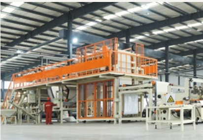
北新防水高分子卷材生产线
